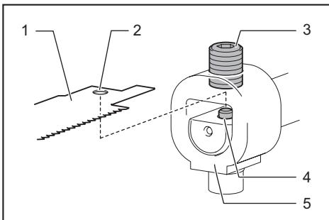
► 1. 手提鋸機鋸片 2. 用於手提鋸機鋸片的孔 3. 螺栓 4. 銳 5. 鋸片夾
