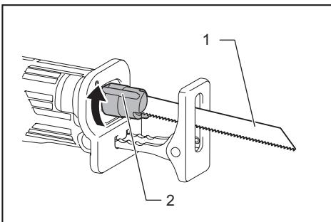
► 1. 手提鋸機鋸片 2. 鋸片夾桿
