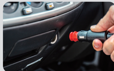
車充(點煙器座)12V/24V DC 插入「DC IN」輸入孔 另一端插入點煙器中
