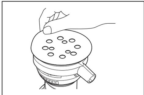
要安裝研磨盤，首先除去墊片上的所有灰塵和異物。然後剝去研磨盤上的襯紙，將研磨盤貼於墊片上。仔細地將研磨盤上的孔與墊片上的孔對齊。
