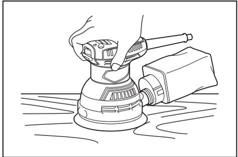
緊握工具。接通工具電源並等待其達到全速。然後輕輕地把工具放在工件表面。將墊片與工件保持平齊並在工具上輕輕施壓。
