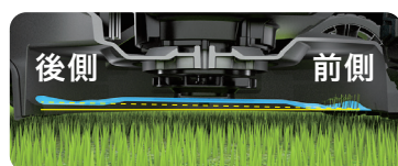
刀片的设计使安裝時向修剪機前側傾斜 以防止雙重切割，減少電流消耗
