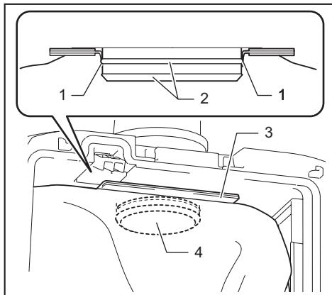
► 1. 過濾袋的橡膠墊 2. 軟管接頭的邊緣
