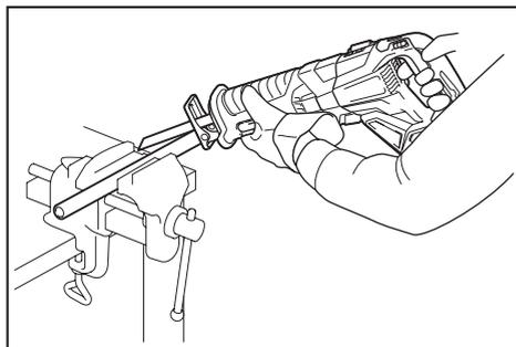
**注意：**請勿在軌座遠離工件或無軌座的情況下，切割工件。此舉會加大反作用力，可能會導致手提鋸機鋸片斷裂。
