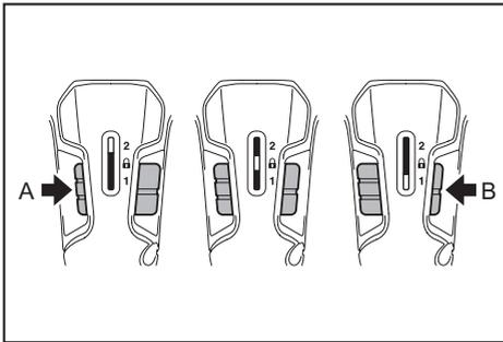
若要啟動工具，從A或B側按下鎖定／速度變換桿，然後扣動開關扳機。在扳機開關上施力越大則工具速度越快。釋放開關扳機便可停止工具。
