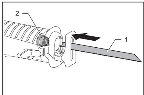
▶ 1. 手提鋸機鋸片 2. 鋸片夾套
