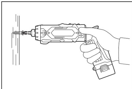
**注：** 擰動木螺絲時，請預先鑽好直徑為木螺絲直徑2/3的導孔。以便釘入螺絲並防止工件裂開。
