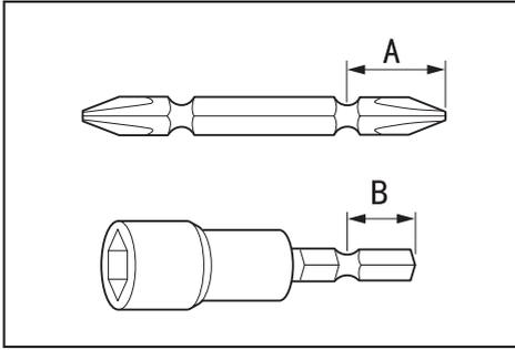
請僅使用帶有圖示插入部分的改錐頭／套筒改錐頭。不得使用其他任何類型的改錐頭／套筒改錐頭。
