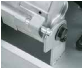
將鋸頭鎖定裝置由鏈鎖更換為梢鎖 (僅適用於LW1400)
