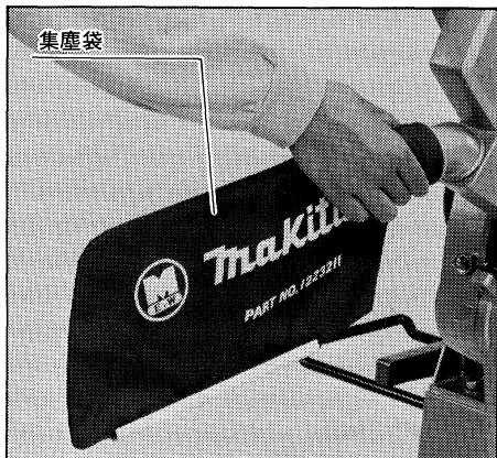
當集塵袋裡的塵屑大約半滿時，從工具上卸下集塵袋並打開閥門。除清集塵袋中的塵屑，輕輕叩打以使粘在集塵袋裡的可能妨礙集塵的顆粒清除掉。
