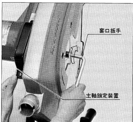
將鋸片安裝在軸上，確認鋸片表面上的箭頭的方向與鋸片架上的一致。裝上外法蘭和六角螺栓，然後用套口扳手按順時針方向確實地擰緊六角螺栓，同時按下軸鎖。
