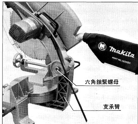
在調整六角鎖緊螺母以後，應該檢查一下，處於任何位置的手柄是否能活動自如地自動返回初始位置。如果六角鎖緊螺母過鬆的話，切割精度將受到影響，如果過緊，則擡上按下手柄將非常喫勁。需要說明的是，這是一個自鎖螺母，它是一個特殊的在正常使用情況下不能自動鬆開的螺母。因而不能過分擰緊它，也不能用其它型號的螺母來取代它。
