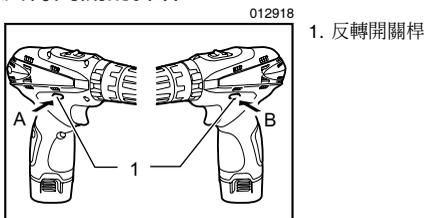
本工具設有反轉開關，可改變旋轉方向。自 A 側按壓反轉開關桿可進行順時針方向旋轉；自 B 側按壓則進行逆時針方向旋轉。
