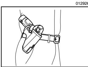
將工具放入皮套中然後使用皮套按鈕鎖緊。
