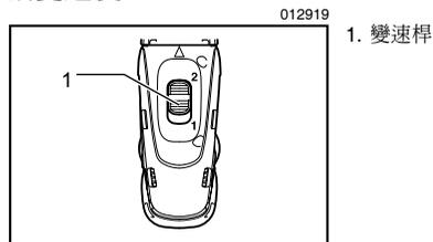
變速操作時，首先將工具關閉，然後將變速桿滑動至「2」側變至高速狀態，或「1」側變至低速狀態。確保使用之前將變速桿置於正確位置。請使用適當的轉速進行工作。
