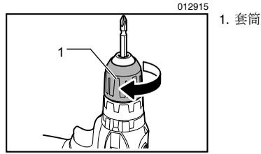
逆時針轉動套筒打開卡盤爪。盡量將起子頭／鑽頭放入卡盤最裡側。順時針轉動套筒旋緊卡盤。
