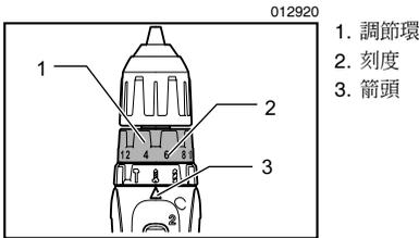
扭力可通過轉動調節環分 18 檔來調節，在調節時要使它的刻度與工具機身上的箭頭對齊。數字 1 對準箭頭時，扭力最小，數字 18 對準箭頭時，扭力最大。
