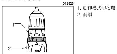
本工具設有動作模式切換環。使用此環可從三種模式中根據作業需要進行選擇。
