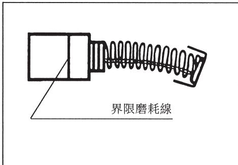
用螺絲起子取下碳刷夾蓋子。取出被磨耗的碳刷，插進新的碳刷，然後擰緊碳刷夾蓋子。
