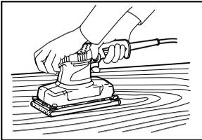
請牢握本工具。啓動工具後應等待其達到全速運轉時再進行操作。將工具輕輕放置於工件表面上。墊片與工件保持平齊，對工具輕微施力。
