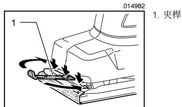
安裝研磨紙時，請拉出夾桿以打開研磨紙夾鉗。將研磨紙一端插入夾鉗。使研磨紙居中並將紙的邊緣與墊片對齊，然後將夾桿返回原位，固定住研磨紙。（預先將研磨紙彎曲可使裝紙更方便。）
