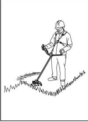
如圖固定肩帶並將工具牢固懸於您的右側以使左手柄的軸總在您在前面。
